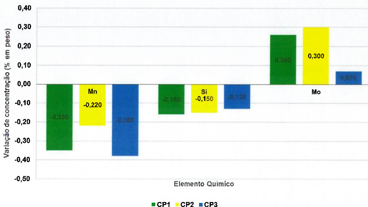
Figura 5.3 – Diferenças dos teores de Mn, Si e Mo em relação ao material de adição.
